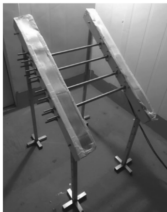
图 5 导线覆冰模拟装置
